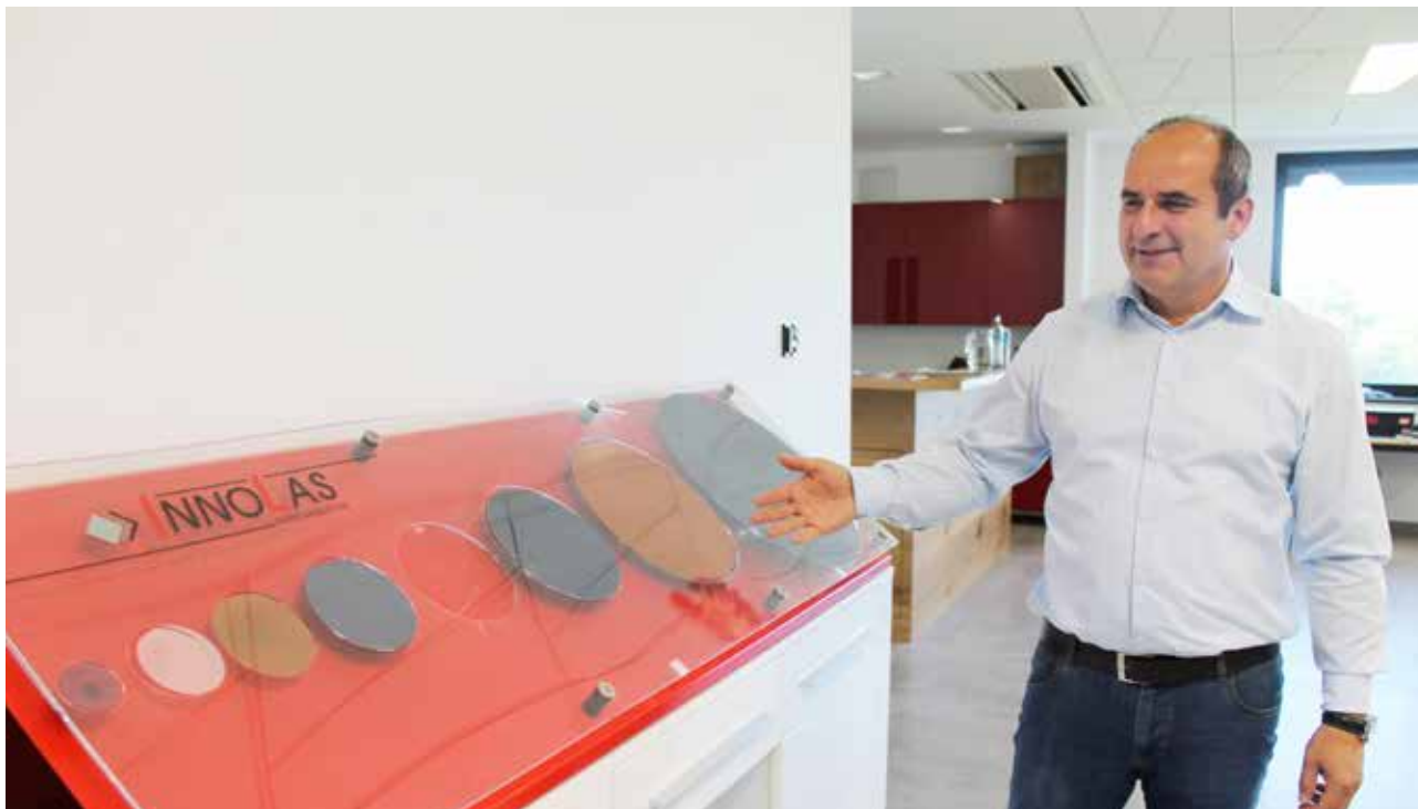
Andreas Behr zeigt einen Schaukasten mit Halbleiterwafern. Wafer stellen das Grundmaterial für nahezu alle elektronischen Bausteine dar. Je nach Einsatzgebiet (Prozessor, Speicher, CCD, Logik, Leistungshalbleiter, etc.) und der entsprechenden Anforderung (Effizienz, Preis, etc.) kommen unterschiedliche Materialien zum Einsatz.
